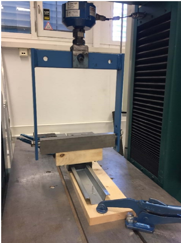
Figur 3. Prøvingsoppsett for takmontering (uttrekk).
