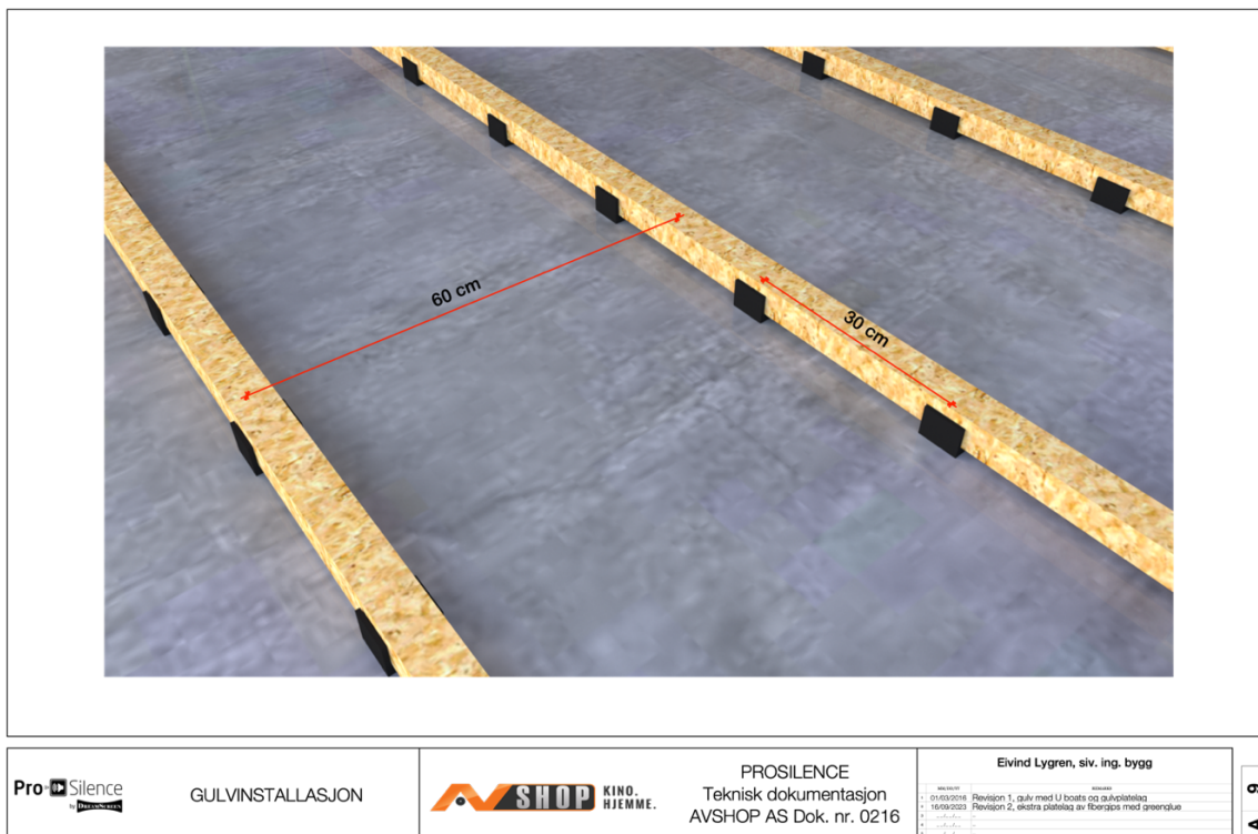
Figur 9: Avstand mellom U-boater er satt til 30 cm, om man har en C-C avstand mellom bjelkene på 60 cm. C-C på 60 gjør det enkelt å legge ned isolasjon mellom bjelkene.
